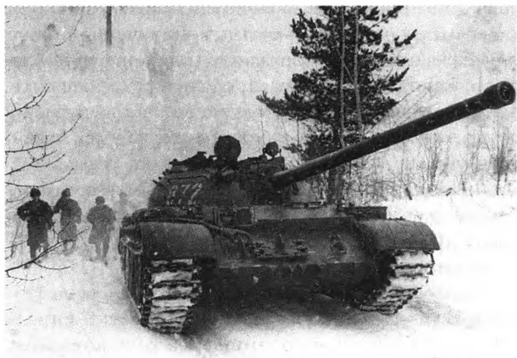
Танк Т-54Б, полученный в результате модернизации Т-54-3.
