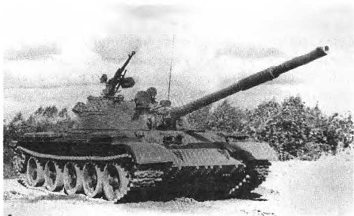
Танк Т-62 выпуска 1972 года. Главным отличием стала установка зенитного пулемета ДШКМ на люке заряжающего.
