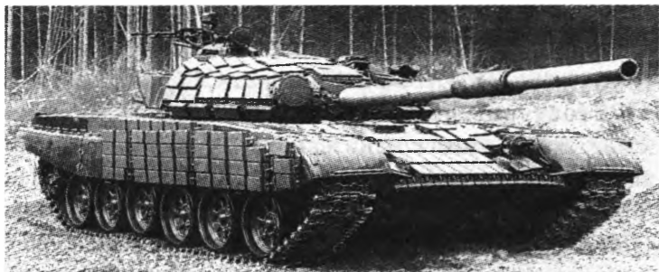
Танк Т-72Б образца 1984 года с навесной динамической защитой.
