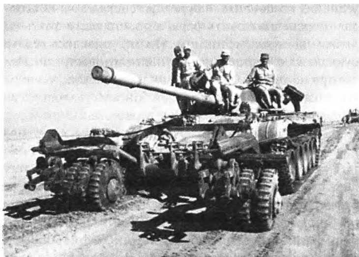
Египетский танк Т-54А, оснащенный катковым минным тралом ПТ-54. 1973 год.
