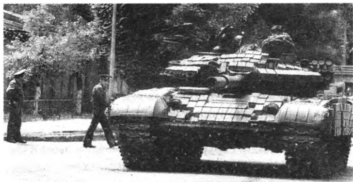
У КПП 201-й мотострелковой дивизии. Танк Т-72АВ, оборудованный навесной динамической защитой в ходе капитального ремонта. Душанбе, 9 мая 1992 года.
