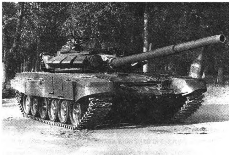
Танк Т-72Б образца 1989 года со встроенной динамической защитой.
