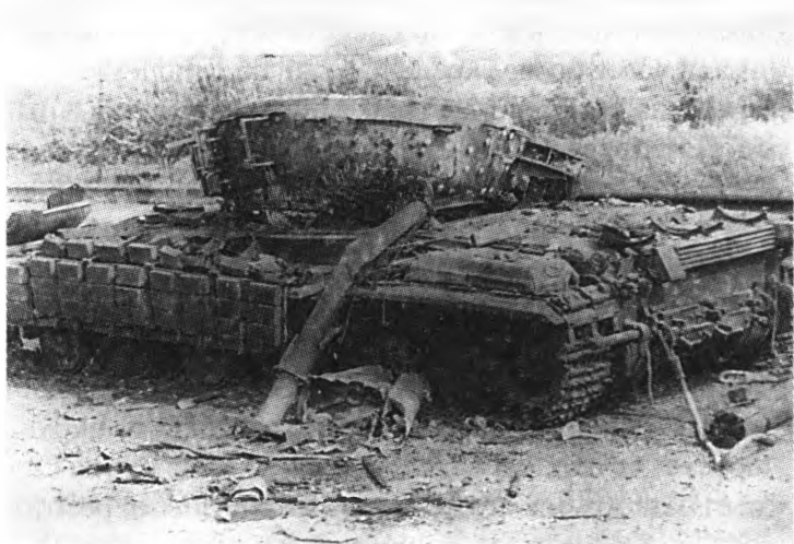
Танк Т-64БВ, подбитый на окраине г. Бендеры. Приднестровье, июнь 1992 года. Башня танка сорвана взрывом боекомплекта.
