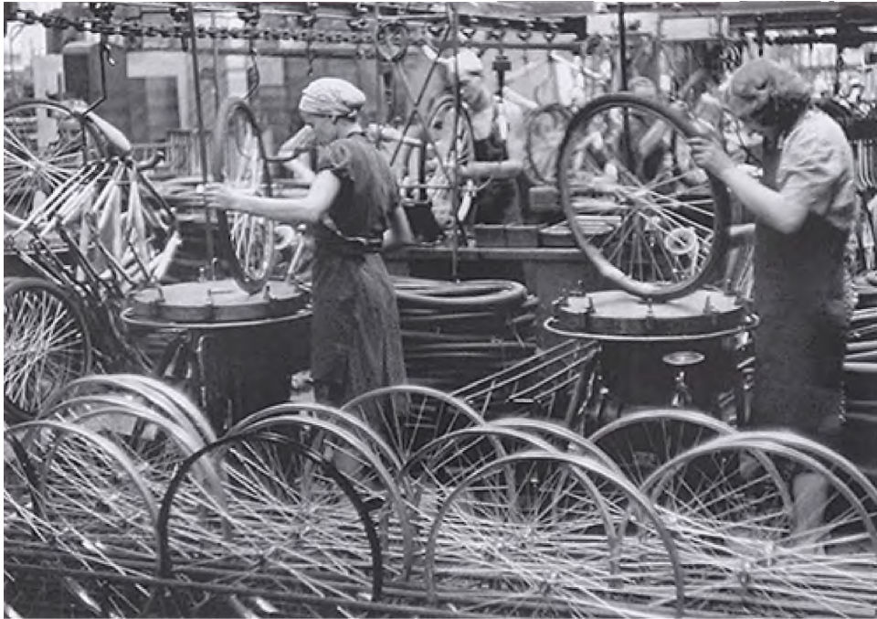
Производство велосипедов на 1-м государственном автомобильном заводе имени Сталина (ЗИС, в 1956 году переименован в ЗИЛ — завод имени Лихачёва). Работницы сборочного цеха устанавливают камеры и покрышки на колеса велосипедов (Москва, 1954 г.).
