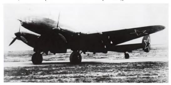
Ер-2 (ДБ-240) — дальний бомбардировщик конструкции инженера В. Г. Ермолаева, двухмоторный моноплан, характерной особенностью которого было крыло типа «обратная чайка». Серийное производство начато в октябре 1940 года; всего было построено 462 машины этого типа. Скорость 420 км/ч, высота полета 7 700 м, экипаж 4-5 чел., практическая дальность 4100 км, максимальная бомбовая нагрузка 3000 кг. Использовался для ударов по военным объектам врага, расположенным в его глубоком тылу.
