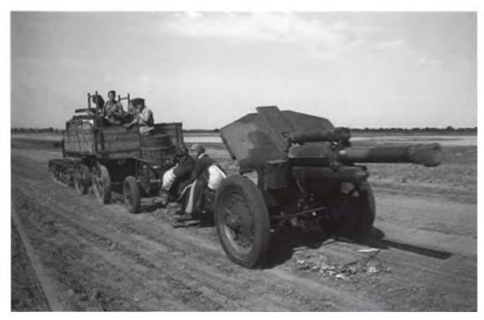
Трактор со 122-мм гаубицей M-30 на пути к Сталинграду; на станинах лафета сидят беженцы (август 1942 г.). Интересно, что на этом снимке трактор, кроме гаубицы, тянет кустарно изготовленный прицеп, в кузове которого сидят красноармейцы, и передок от другого орудия с железной бочкой (гаубица M-30 транспортировалась без передка).
