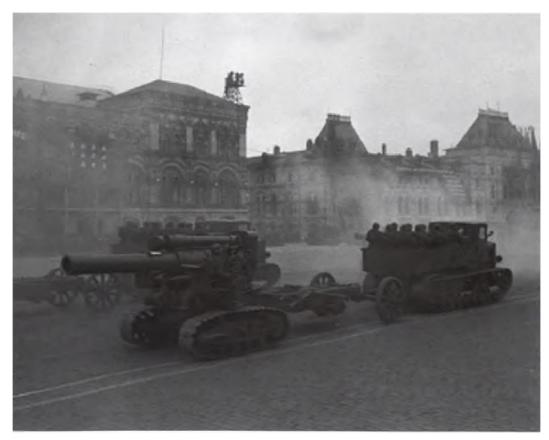
Артиллерийские тягачи «Ворошиловец» буксируют гаубицы Б-4 на военном параде на Красной площади 1 мая 1936 г. Ниже: 203-мм гаубица образца 1931 года (Б-4) устанавливалась на шасси трактора и отправляла фугасный или бетонобойный снаряд весом 100 кг на расстояние 18 км. Более 140 таких орудий использовались во время Советско-
