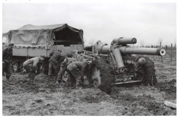
Из-за нехватки резины колеса германских орудий делали из стали; из-за этого скорость движения снижалась, а тянуть орудия на таких колесах было тяжелее, и лошади быстрее уставали. На мощеной камнем дороге такие колеса громыхали, в песке, грязи и снегу — застревали.
